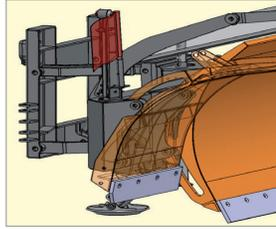
Durch seinen Ausgleichs-Pendel-Mechanismus (bis 18°) passt sich der Schneepflug optimal dem Bodenprofil an.
